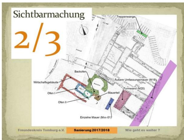
Die Spritzbetonwand verläuft parallel zur Innenkante der Äußeren Umfassungsmauer. Deren Befund konnte bisher nur an dieser einen Stelle nachgewiesen werden. Daher ist geplant, die Umfassungsmauer ebenso wie die Fundamente der Wirtschaftsgebäude aufzumauern. Das neue Mauerwerk schützt dann als „Verschleißschicht“ die darunter liegende Bausubstanz des 15. Jahrhunderts. Eine Abstufung im Mauerverlauf vom Standpunkt des Bildes aus bis auf das Höhenniveau der Arbeitsplattform machen die
